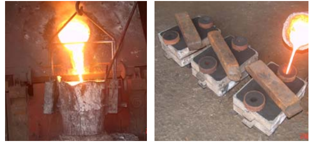
圖十三 側封材料鑄造過程
