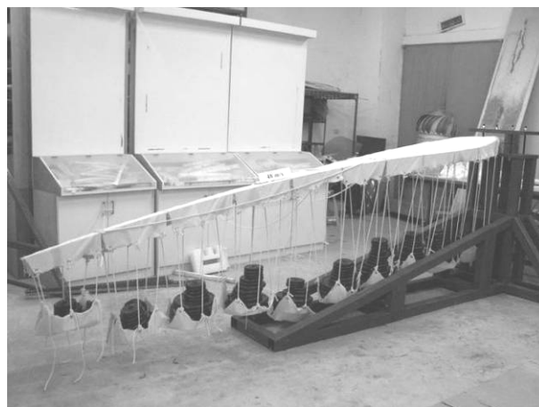
圖 14 葉片於風速 48m/s 時之靜態載重
