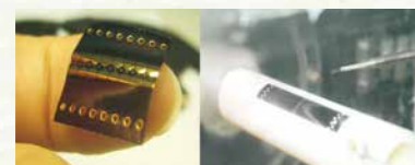
可撓感測器陣列成品及其安裝於圓柱模型風洞測試圖
